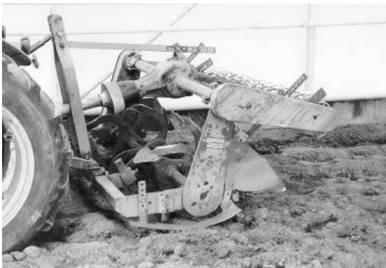
Figuur 2-14: De spitsfrees met eggenrol wordt het meest gebruikt voor de grondbewerking in de glastuinbouw.
